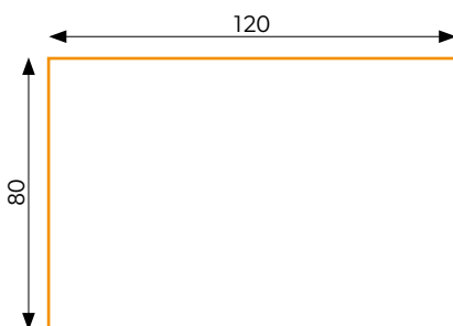
Obróbka maskująca połączenie dwóch kasetonów O04
